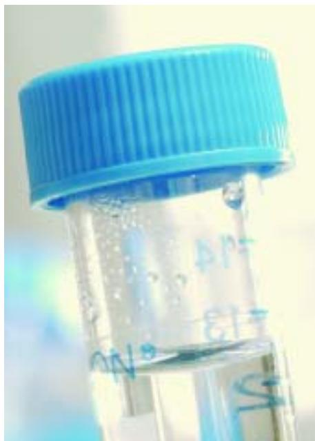
*Vidrio tipo II:* obtenido a partir del vidrio de tipo III al que se somete a un tratamiento en caliente, lo que le da un aspecto no totalmente transparente, que desaparece al lavarlo. Se utiliza para contener soluciones parenterales que tengan un pH < 7, es decir, ácidas o neutras.
